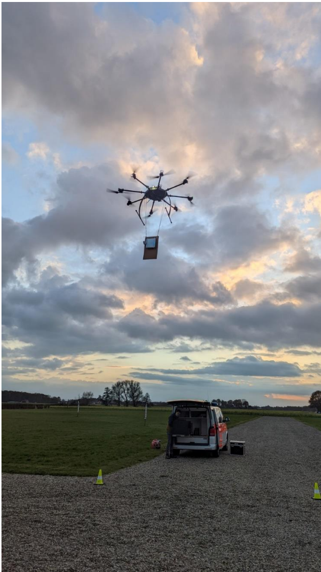
Abbildung 10 Drohnenflug mit LoRaWAN Gateway
