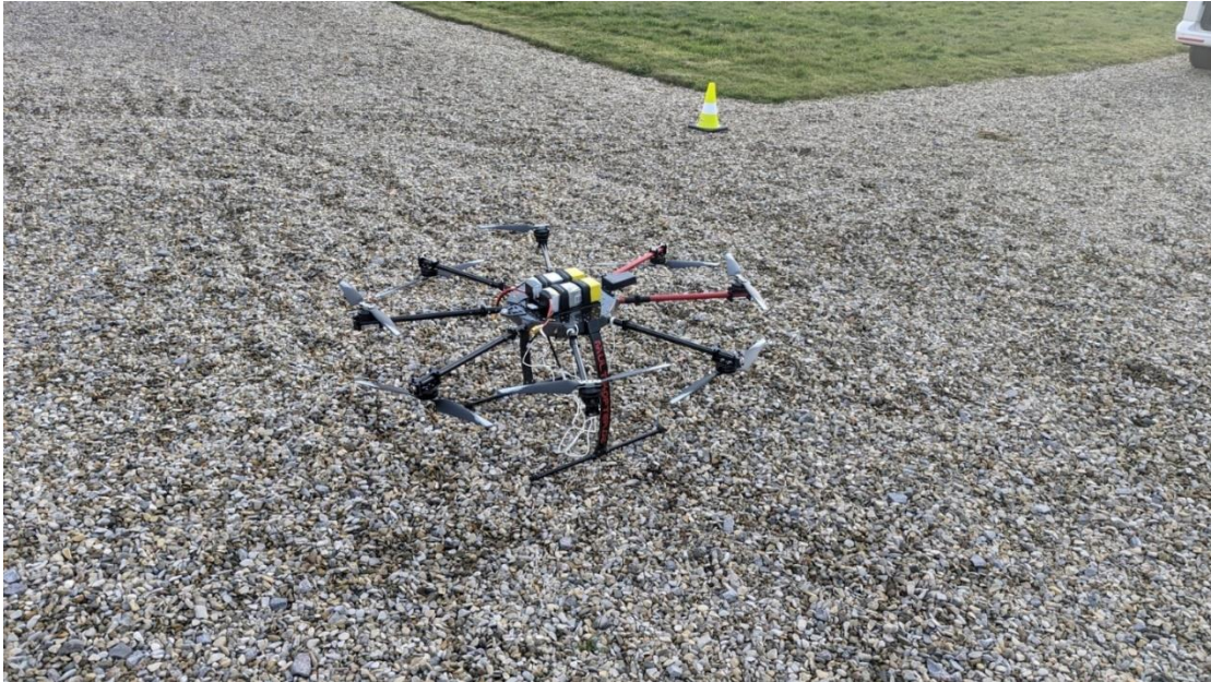
Abbildung 9 Drohne mit LoRaWAN Gateway
